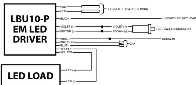
**EMERGENCY DRIVER AND AC DRIVER MUST BE FED FROM THE SAME BRANCH CIRCUIT**
